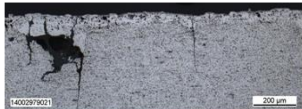
Bild 5 Schliffbild nach AC-3 Lebensdauer
